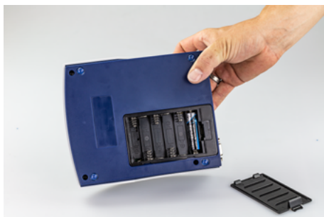
Fig. 17 : logement des piles
