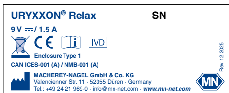
Fig. 7 : Exemple de plaque signalétique
