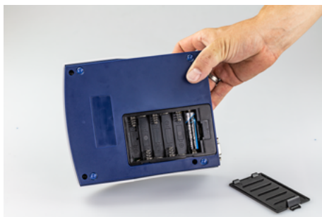
Fig. 17: Vano delle batterie
